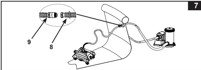
9. Installez l'épurateur en vous conformant aux instructions de montage de l'épurateur. Le robot est maintenant prêt à être utilisé.
