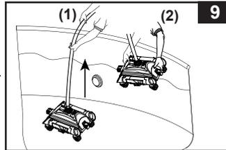
3. Maintenez la base du robot avec les deux mains, levez lentement le robot en inclinant la tête du robot vers l'avant ou l'arrière. Figure.10. Une fois le robot complètement vide, soulevez-le avec les 2 mains.
