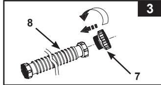
4. Vissez l'extrémité du tuyau A (8) avec adaptateur au support de crépine depuis l'intérieur de la piscine. Figure. 4.
